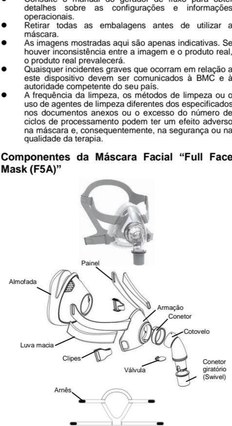
Nota: O Armação da máscara é composto por Armação, Painel, Luva macia, Conetor, Conjunto do Cotovelo. O Conjunto do Cotovelo é composto por Cotovelo e Válvula. Componentes da máscara facial "Full Face Mask (F5A)"
